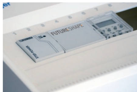
Abb. 4: SensFloor Empfänger mit Stromversorgung und Zeitschaltuhr zum Einbau in eine Hutschiene.
